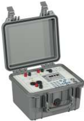
CheckSource 2.3, Dreiphasige Stromquelle
