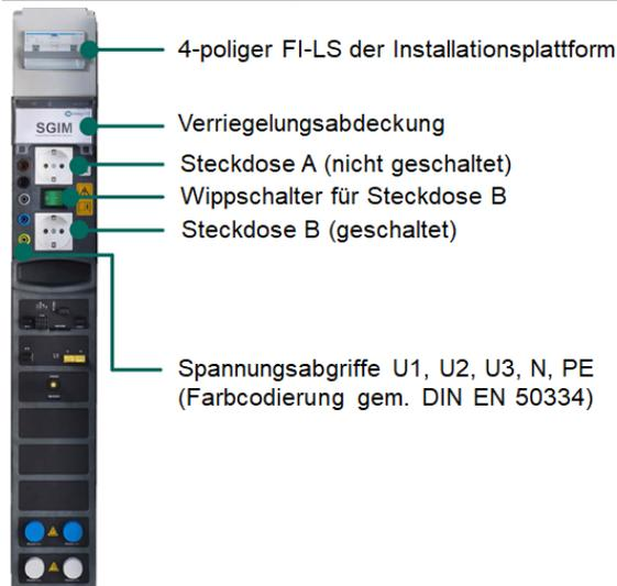
Das SGIM besteht aus zwei Hauptteilen: der Installationsplattform und dem Smart Grid Interface Modul Einsteckeinheit. Diese enthält alle erforderlichen Steuerungs-, Kommunikations-, und Messfunktionen, um Messdaten entweder für ein Cloud-basiertes Datenmanagementsystem oder über Leittechnik- und Schaltanlagenprotokolle (DIN EN 60870-5-104, DIN EN 61850, DNP 3.0) oder Industrieprotokolle (OPC/UA) zur Verfügung zu stellen.
