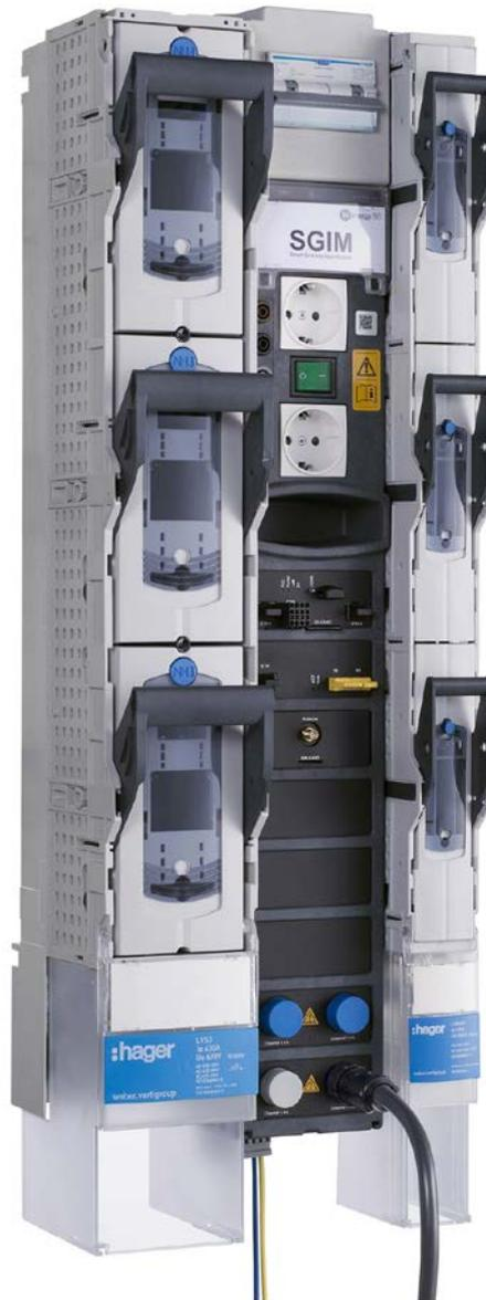
Das Smart Grid Interface Modul SGIM ist ein einfach zu installierendes Messsystem zur Digitalisierung von Ortsnetzstationen und Kabelverteilschränken im intelligenten Verteilnetz. Es ermöglicht den kostengünstigen und unterbrechungsfreien Einbau im 185mm-Sammelschienensystem in Verbindung mit NH-Sicherungs-Lastschaltleisten gem. DIN EN 61439/60947 und somit den Aufbau eines Monitoring-Systems an neuralgischen Stellen und Knotenpunkten im Verteilnetz.
