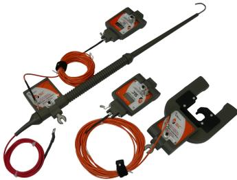
AmpLiteWire und VoltLiteWire Sen-soren für Spannungs- und Strommess-ungen bei hohen Spannungspoten-tialen bis zu 40 KV und Strömen bis 2000A.
