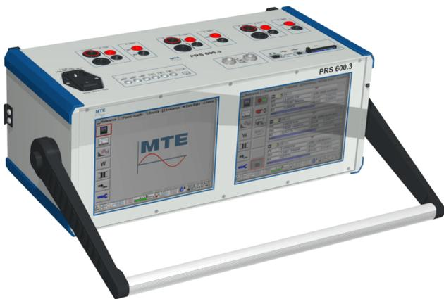
Der Prüfzähler des modularen Systems basiert auf der erprobten digitalen Messerfassung, schneller Analog-Digitalkonvertierung und Berechnung der Werte mit Hilfe schneller Signalprozessoren. Heute werden Prüfzähler, im Gegensatz zu früher, nicht nur als stationäre Normale für die Zählerprüfung in einer Prüfeinrichtung, sondern zunehmend im Feld zur Messung der gesamten Netzparameter eingesetzt.
