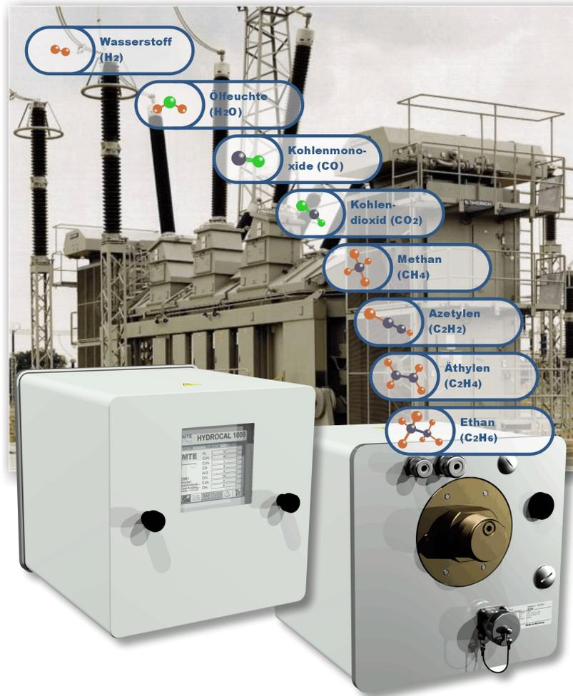
Der HYDROCAL 1008 ist ein festinstalliertes Multi Gas in Öl Analysesystem mit Transformator Überwachungsfunktionen. Es misst individuell die Ölfeuchte ( $H_2O$ ) und die im Transformator Öl gelösten Schlüsselgase Wasserstoff ( $H_2$ ), Kohlenmonoxid ( $CO$ ), Kohlendioxid ( $CO_2$ ), Methan ( $CH_4$ ), Azetylen ( $C_2H_2$ ), Äthylen ( $C_2H_4$ ) und Ethan ( $C_2H_6$ ).
