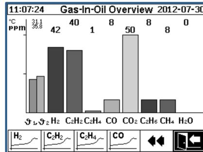
Individuelle Balkendiagramme für Wasserstoff (H<sub>2</sub>), Kohlenmonoxid (CO), Kohlendioxid (CO<sub>2</sub>), Methan (CH<sub>4</sub>), Azetylen (C<sub>2</sub>H<sub>2</sub>), Äthylen (C<sub>2</sub>H<sub>4</sub>), Ethan (C<sub>2</sub>H<sub>6</sub>), Ölfeuchte (H<sub>2</sub>O) und Temperaturen.
